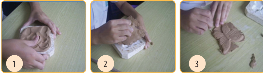
Gambar 1.17. Proses cetak kering dengan cara ditekan ( press ).
