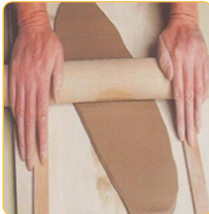
Sumber: Dok. Kemdikbud Gambar 1.15. Tanah digulung dengan rol.
